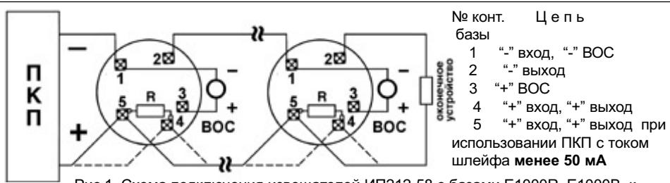
Рис.1. Схема подключения извещателей ИП212-58 с базами Е1000R, Е1000B к ПКП. В базе Е1000В резистор и 4-й контакт не установлен.
