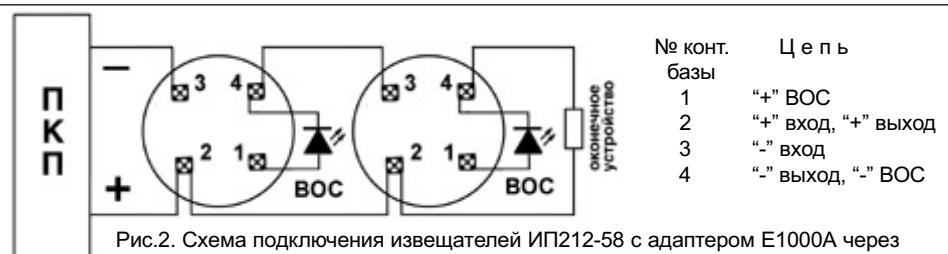
Рис.2. Схема подключения извещателей ИП212-58 с адаптером Е1000А через розетки от ДИПов к ПКП с током шлейфа **менее 50 мА**
