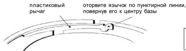
Рис. 1. Активизация функции защиты от несанкционированного извлечения извещателя
